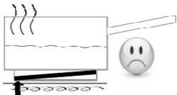
Ferromagnetisches Element wurde schlecht eingebaut
