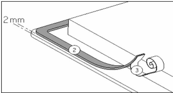
Die Dichtung (2) nach Abnehmen der Schutzfolie (3) mit 2 mm Abstand der Außenkante des Glases aufkleben.
